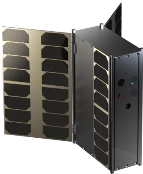
Slika 13 - Model međuplanetarnog 6U kjob satelita APEX
